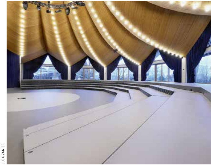
▲ Das Holzbauunternehmen fertigte 470 Akustikelemente für die Innenverkleidung
